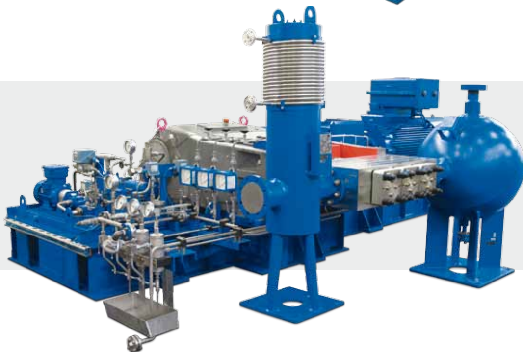
Groupe motopompe haute pression KD823 pour NH 3 liquide avec amortisseur de pulsations partiellement chauffé à l'aspiration, résonateur au refoulement et circuit d'huile de lubrification
