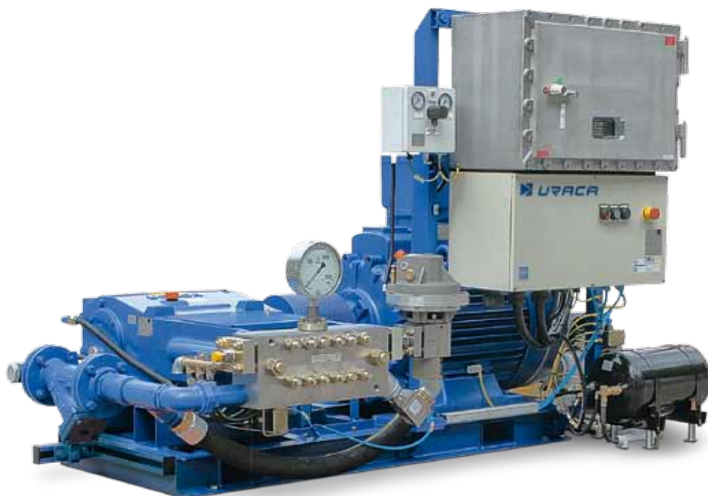
Groupe motopompe haute pression KD719 sur châssis en version ATEX
